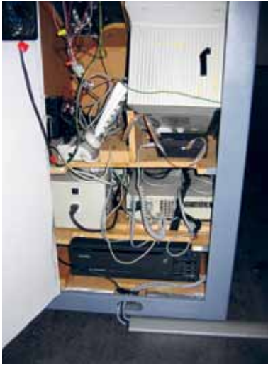
Dispositif ouvert de l'installation Karlsruhe Moviemap (version 1991) Les composants utilisés à l'origine - Apple Macintosh Portrait Display (en haut), Apple Macintosh IIsi et lecteur de disque laser Pioneer LD-V8000 (en bas) - sont nettement visibles © ZKM | Karlsruhe
